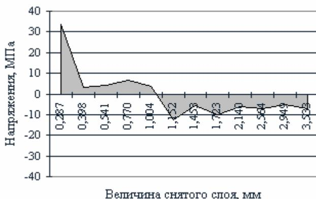
Рис. 9. Эпюра распределения напряжений в биметаллическом вкладыше после термообработки в «заневоленном» состоянии
