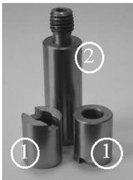
Рис. 4. Испытательные образцы: 1 – короткие (горизонтальные) образцы, 2 – длинный (вертикальный) образец
