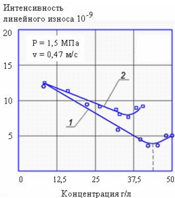
Рис. 3. Зависимость интенсивности линейного износа от концентрации частиц: 1 – дисульфида молибдена, 2 – графита
