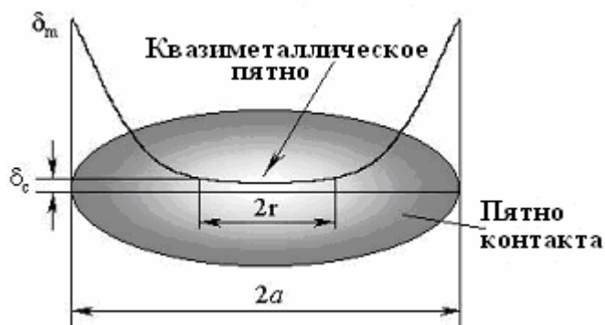
Рис. 2. Схема контактного пятна с поверхностной пленкой переменной толщины
