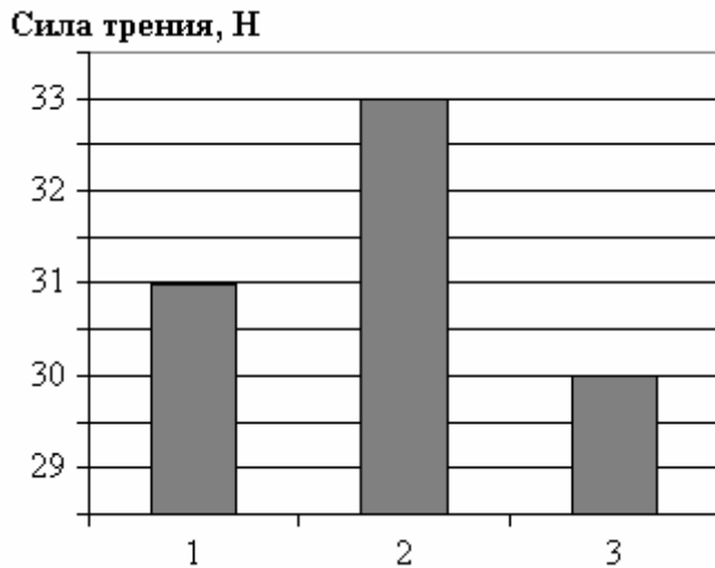
Рис. 3. Сила трения индентора, выполненного из стали X18H9T (1), резины ИРП-10214 (2) и АСЧ-6 (3), по резине АСЧ-6
