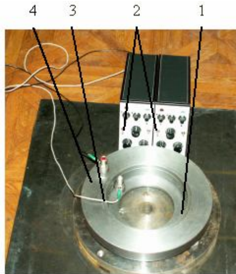
Рис. 6. Фото стенда для динамического исследования свойств виброизолятора на ударные воздействия: 1 – виброизолятор;
