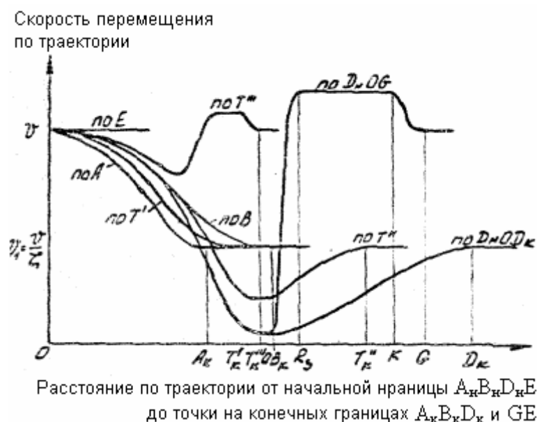
Рис. 2. Диаграмма изменения скоростей перемещения материальных точек вдоль траекторий их движения относительно неподвижного инструмента
