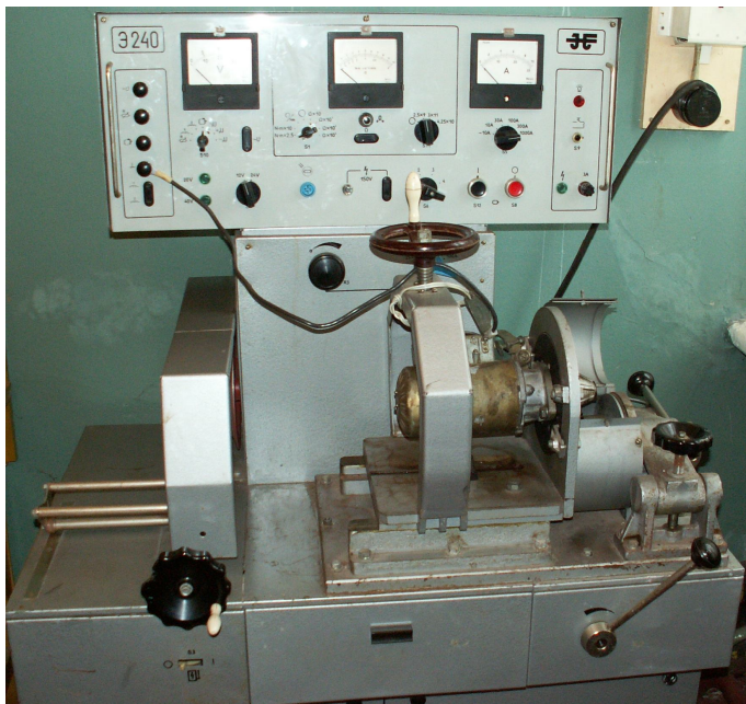
Рис. 4. Стенд контрольно-испытательный модели Э-240
