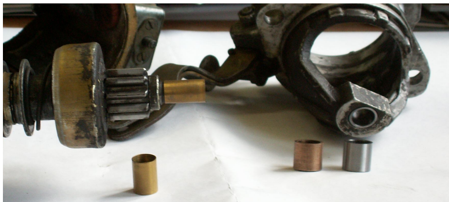
Рис. 5. Втулки на валу стартера и в корпусе
