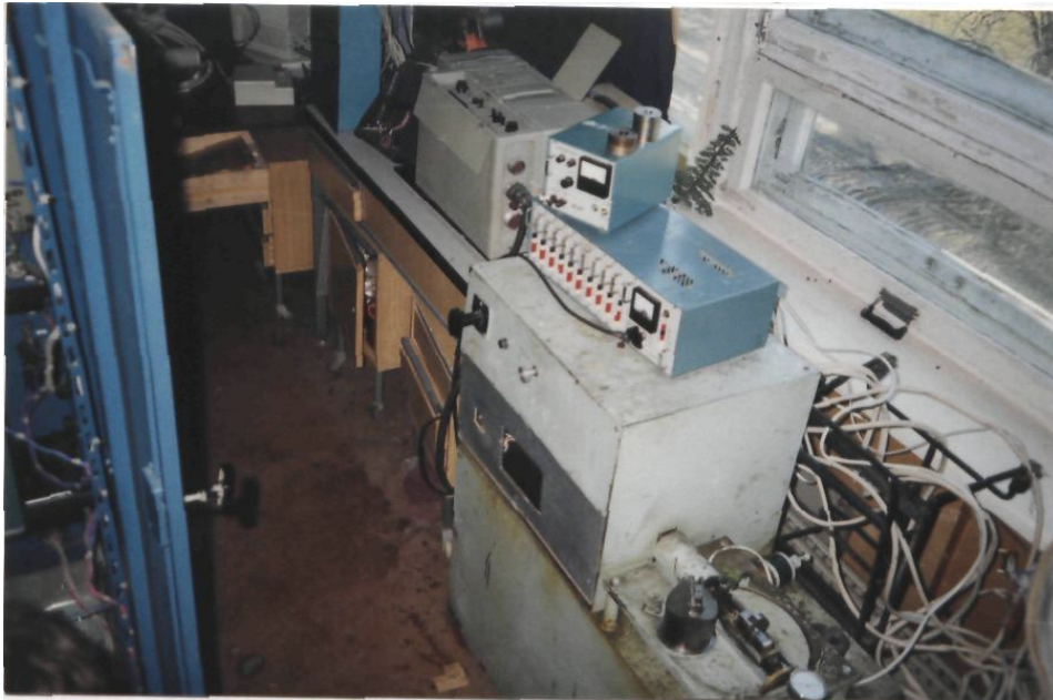
Рис. 2. Общий вид установки по изучению фреттингостойкости покрытий
