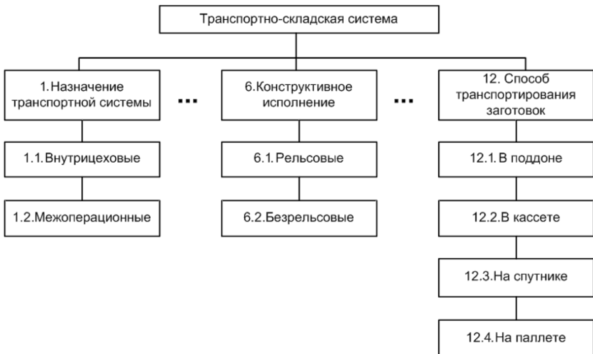
Рис. 2. Функциональная структура транспортно-складской системы
