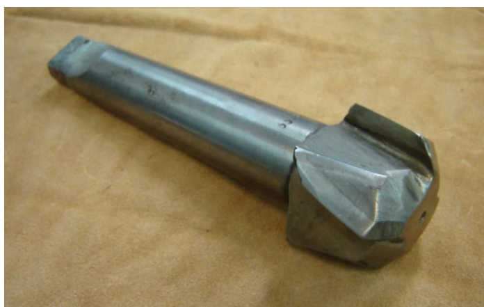
Рис. 3. Этапы изготовления зенкера: а – наплавленная рабочая часть зенкера; б – зенкер после шлифовки
