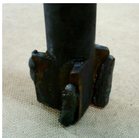
Рис. 3. Этапы изготовления зенкера: а – наплавленная рабочая часть зенкера; б – зенкер после шлифовки
