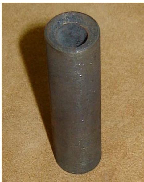
Рис. 2. Наплавленный образец патрубка Рис. 3. Микроструктура наплавленного металла
