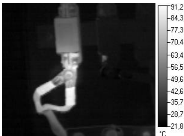
Теплограмма контактного соединения при напряжении 220 В и токе 87 А
