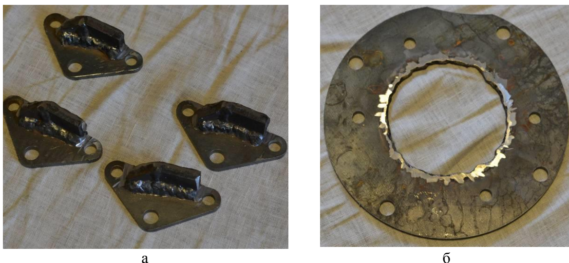
а б Рис. 4. Восстановленные детали заборного узла корпуса шламового насоса: а – отражающие пластины; б – диск
