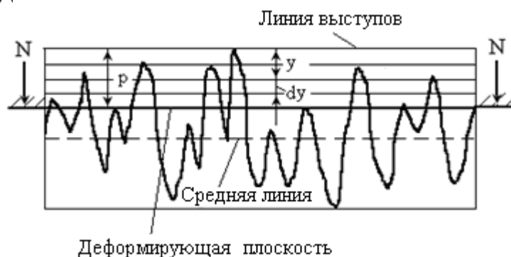
Рис. 1. Контактрование шероховатой поверхности с гладкой. Модель Н.Б. Демкина
