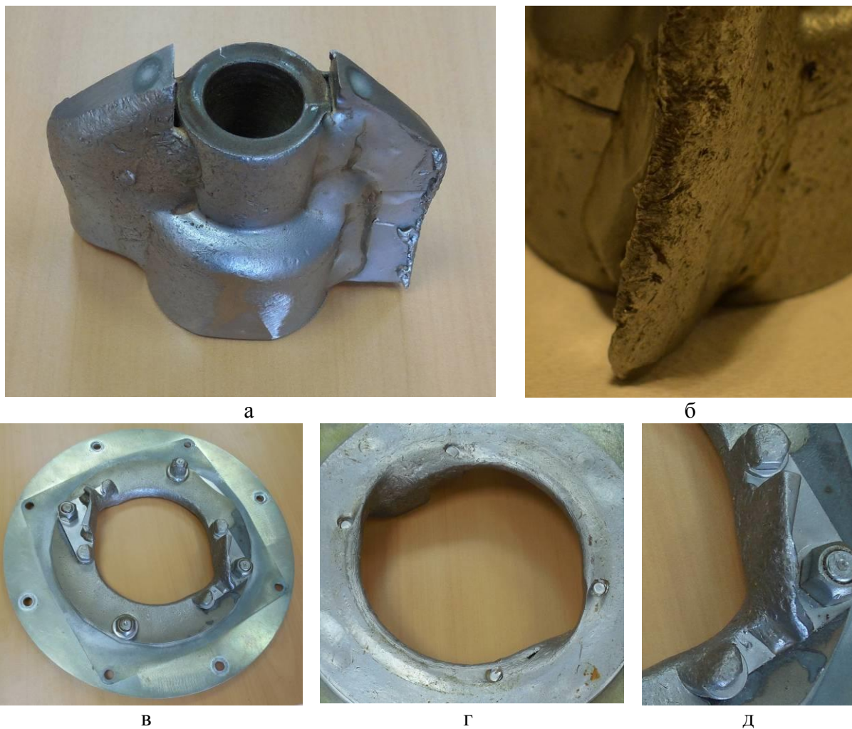
Рис. 1. Изношенные детали шламового насоса: а – мешалка (общий вид); б – лопатка мешалки (увеличено); в – заборный узел (общий вид); г – диск; д – отражающие пластины
