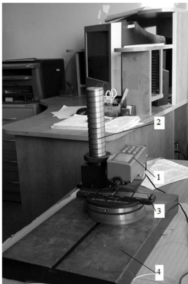
Рис. 1. Комплект оборудования для исследования топографии технических поверхностей
