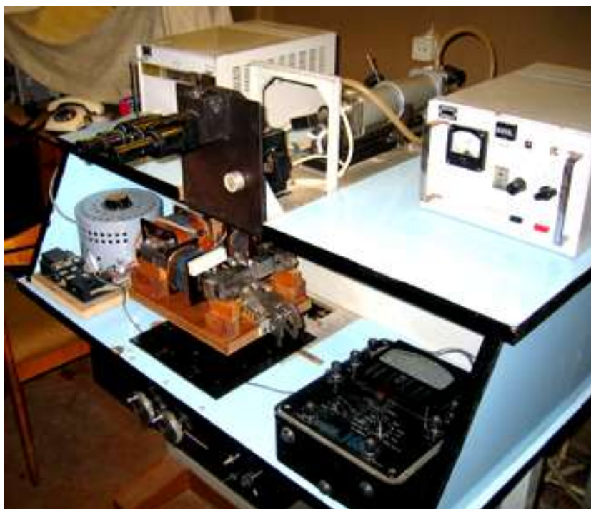
Рис. 1. Установка лазерного излучения «КВАНТ-16» для формирования анизотропных состояний в образцах при обработке в поле тороидального электромагнита
