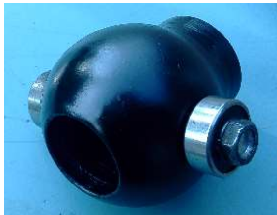
Рис. 3. Сферическая часть муфты, выполненная из капролона-42
