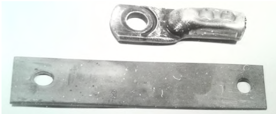
Кабельный наконечник и токоведущая шина из алюминиевого сплава
