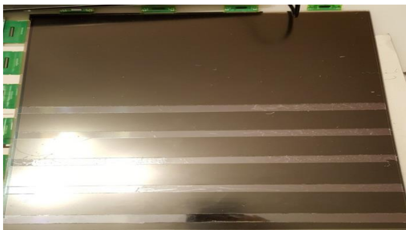
Рис. 2. ЖК-матрица с отделенными полимерными пленками
