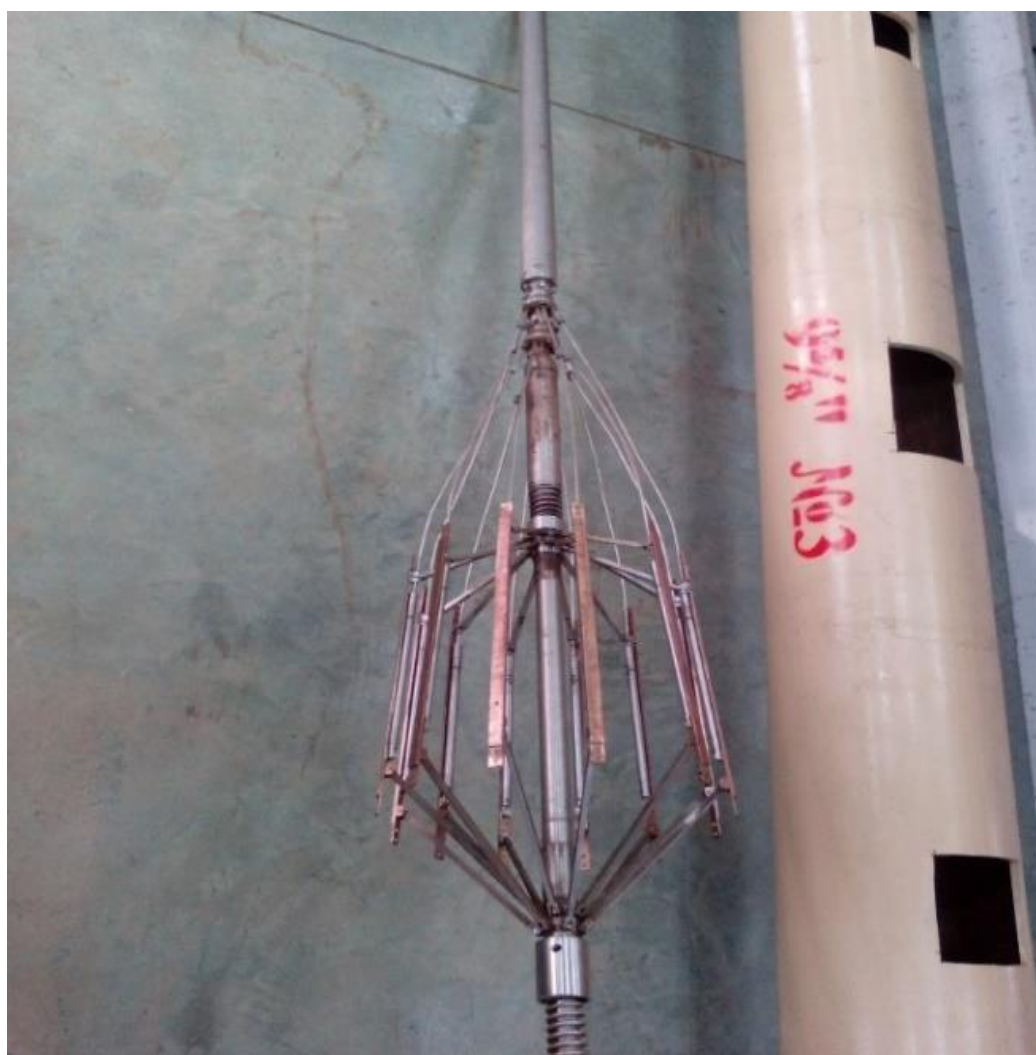
Рис. 3. Исследование износа рессор прибора в воздушной среде
