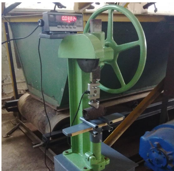
Рис. 2. Испытание на изгибную прочность образцов кускового торфа
