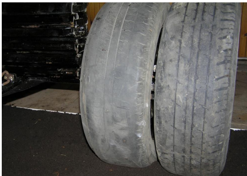
Рис. 2. Сдваивание колес модели пневмоколесного хода
