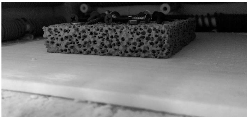
Рис. 7. Загрязненный пенокерамический фильтр
