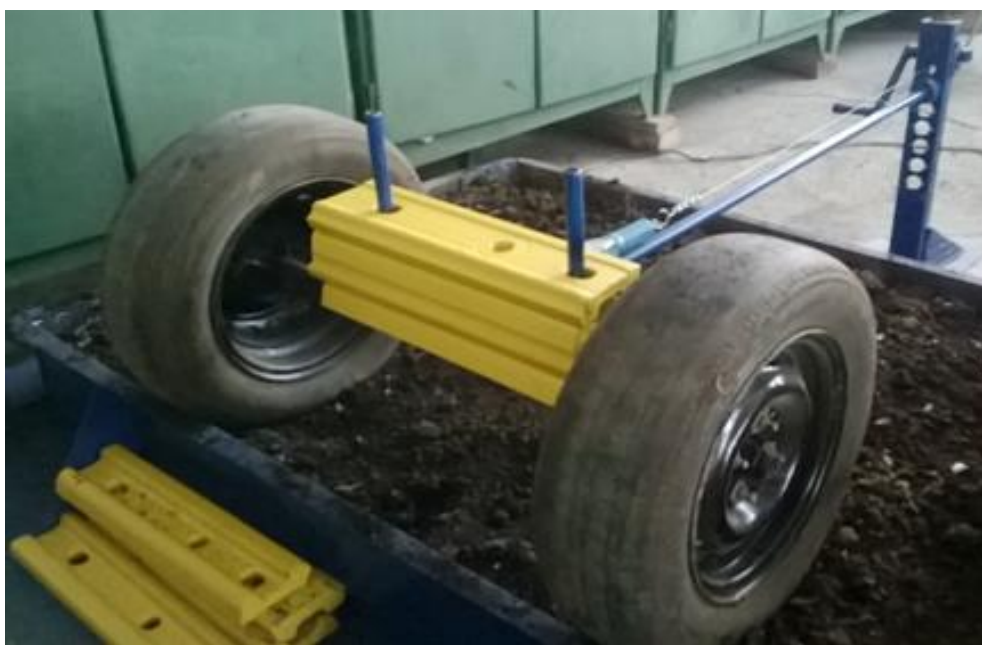
Рис. 1. Модель пневматического колесного хода: а – лабораторная; б – смонтированная и находящаяся в лаборатории кафедры «Технологические машины и оборудование»
