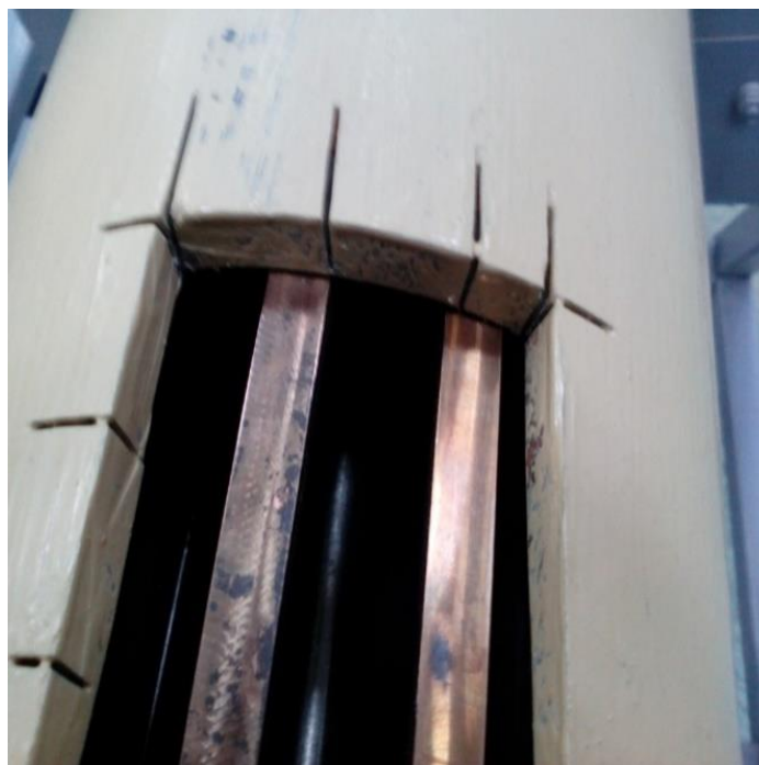
Рис. 4. Схема взаимодействия рессор с обсадной трубой
