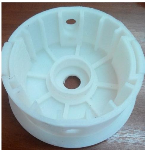
Корпус, выполненный с помощью 3D-печати (материал – АБС-пластик)
